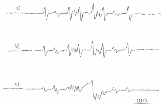
Fig. 4 Dithranol溶液にキセノンランプを照射した時に観察されるESRスペクトル。 5mM Dithranol溶液(DMSO-PBS(1:1))に a) 調製直後、b) 20分間暗所に放置後、および c) 20分間キセノンランプ照射後180 mM DMPOを添加して測定。
